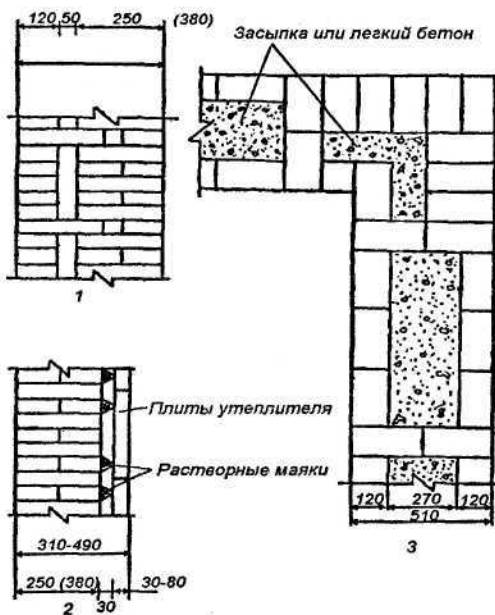
Рис. 11. Стены бани из кирпича и камня:
